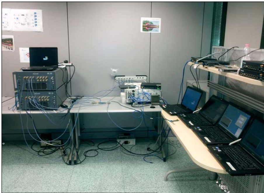
Figura 2 - Banco di misura con rete propagativa ed interno carrozza
